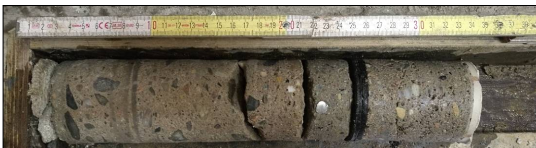
Obr. č. 2 - diagnostický vrt N2, skrze strop nad 1. NP
