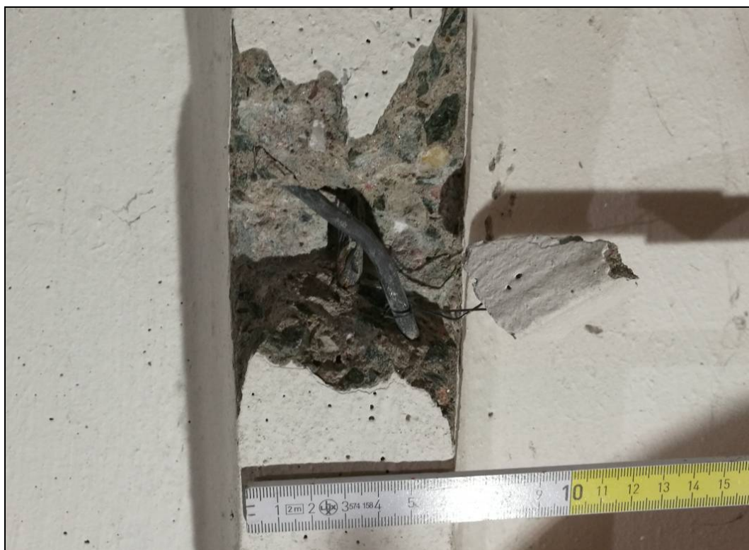
Obr. č. 10 - bouraná sonda BS6 do žebra ŽB prefa nosníku
