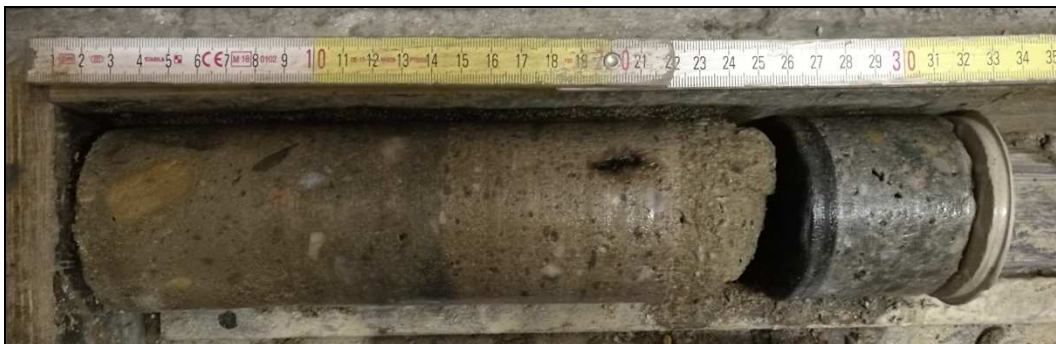
Obr. č. 1 - diagnostický vrt N1, skrze strop nad 1. NP
