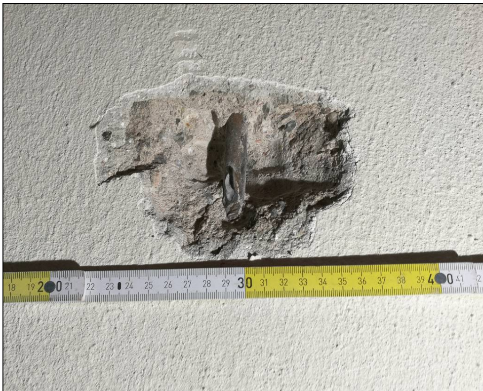
Obr. č. 8 - bouraná sonda BS5 do průvlaku mezi sloupy v 1. PP
